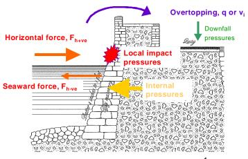
Figure 3—Wave-driven Loadings<sup>1</sup>
